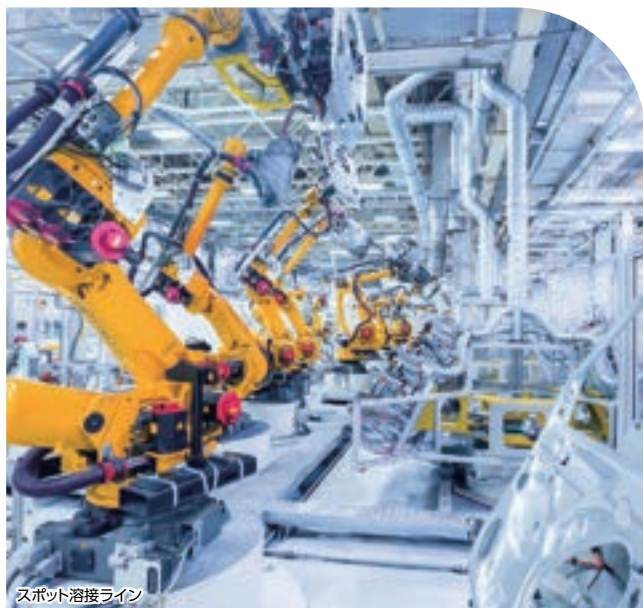
スポット溶接ライン
